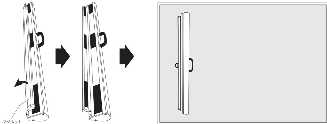
(2) 片手でハンドルを、もう片方の手でケースの下側を持ち、ハンドルが正面に見える方向に本体ケースを傾け、押さえローラー部分を黒板に押しつけながら右図の矢印の方向へスクリーンを引き出します。STOPマークが出たら引き出すのを止めて、本体ケースを傾け直して設置面に本体ケースを固定してください。
