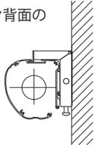
③ 固定用ネジを締込みスクリーン全体を持ち上げL字金具とスクリーンを固定します。
