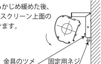
② 金具のツメにスクリーン背面のスリットを合わせます。
