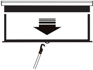
スクリーンの引き下げには付属のフック棒を使用して、手が届く位置まで引き出します。
