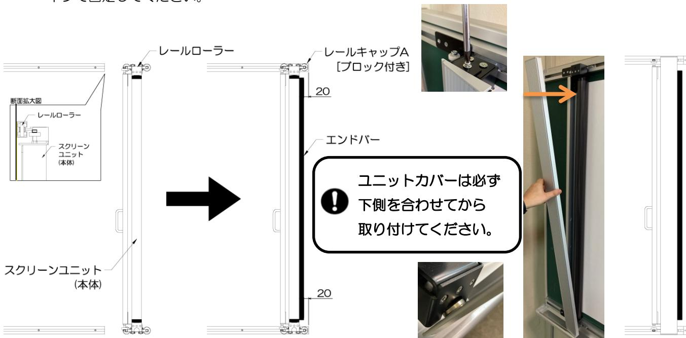
上下レールローラー部を同時に設置面方向に押し付けながら、差し込んでください。
