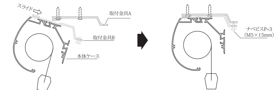
**警告** **!** 壁面取付の際は、付属のナベビスP=3(M4×10mm)を必ず使用してください。落下の危険があります。
