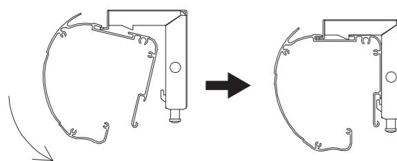
④固定用ネジを締込みスクリーン全体
