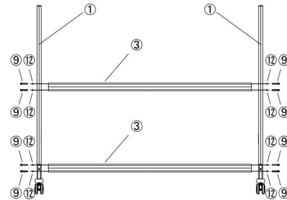
1で組み立てたスタンド支柱の間に③ステイ2本を8組の⑫M8スプリングワッシャー⑨M8キャップボルト(L=50)にて⑭六角レンチを使用して緩めに固定する。
