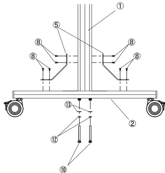
②キャスター付き台に⑩M8キャップボルト(L=70)2本と⑫M8スプリングワッシャー2個⑬M8平ワッシャー2枚を⑭六角レンチを使用して緩めに固定する。⑤ステンレス補強材2個を⑧M4皿ネジ各4本を使用しプラスドライバーで固定した後、⑩を完全に締め付ける。同様の組み立て方法により、もう1セット組み立てる。
