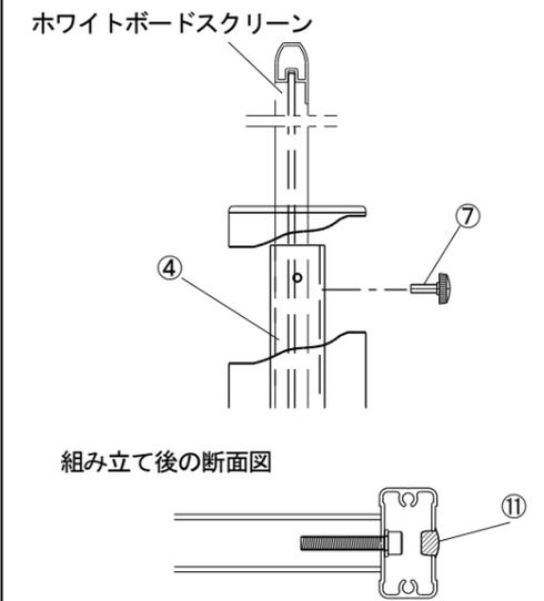
ボードスクリーンの両側に④ボード固定金具を取付けた後、背面にあるネジ穴に付属の⑦白色化粧樹脂ネジを使用して、左右各2箇所ずつボードスクリーンが動かないように固定する。
