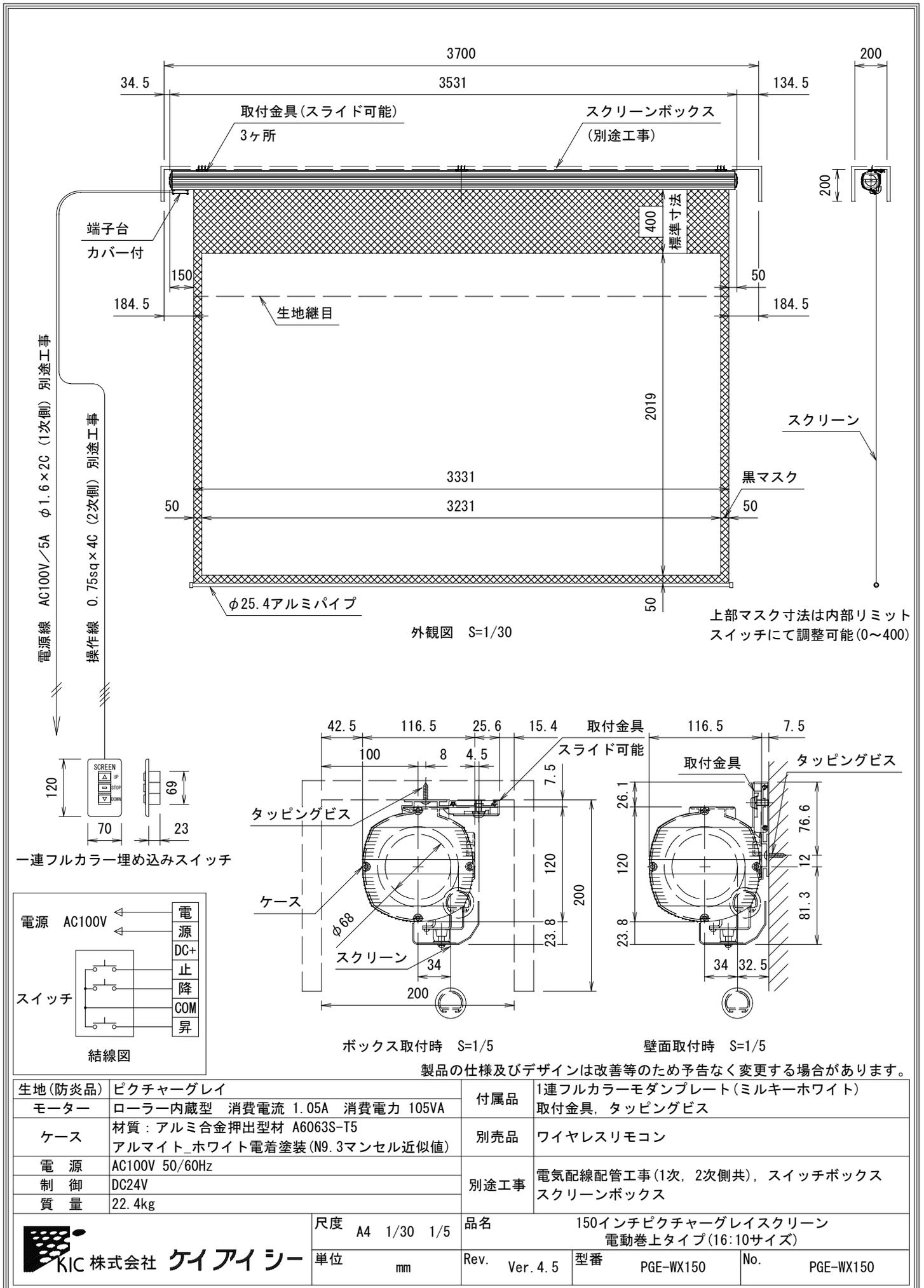
上部マスク寸法は内部リミットスイッチにて調整可能(0~400)
