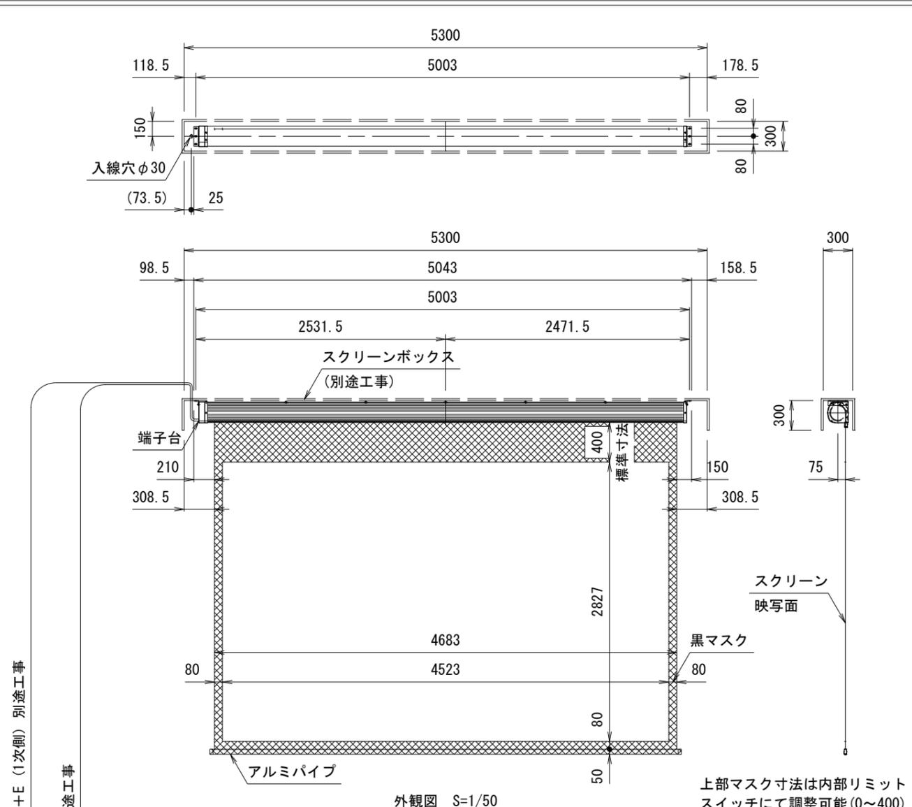
電源線 AC100V/5A φ1.6×2C+E (1次側) 別途工事
