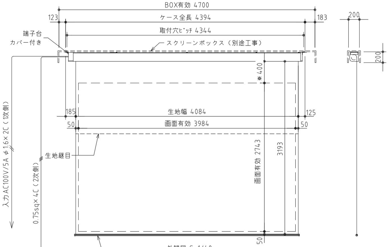
※上部マスク寸法は内部リミットスイッチにて調整可能(0~400)
