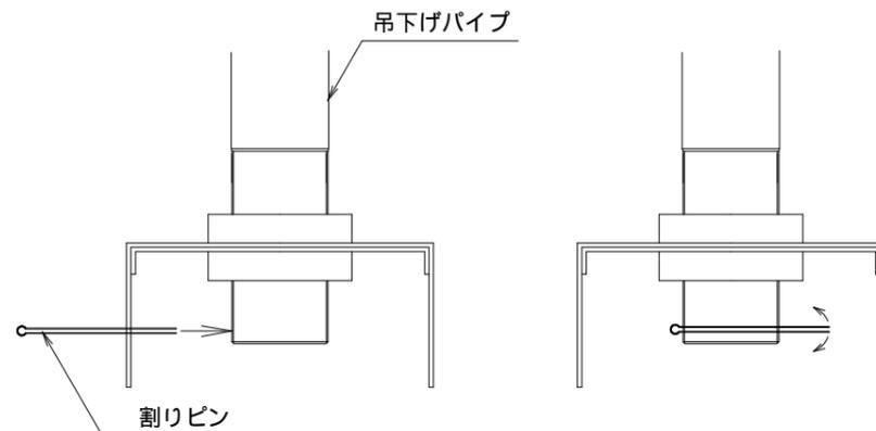
**6** ハンガーブラケットのA部に ベース金具-ハンガーブラケット取付ボルト(六角穴付きボルトM8×25)を約10mm出した状態で取付け, a部に引っ掛ける。Bとbを合わせ, ボルトで軽く締め, 角度調整した後AB共しっかり締め付ける。安全の為 プロジェクター固定ベルトで アタッチメントとプロジェクターを固定する。
