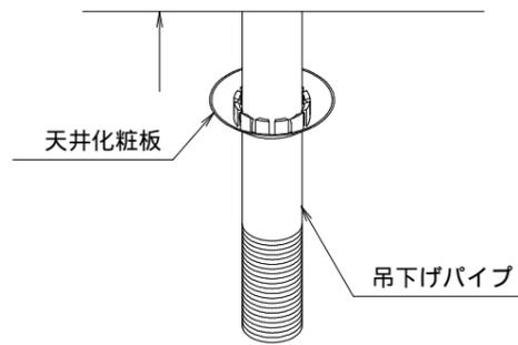
**2** 吊下げパイプに 吊下げパイプ用ナット1個をねじ込み, ハンガーブラケットに当て, もう1個の で取付。
