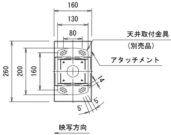
注文時に取付するプロジェクトーをご確認ください、アタッチメントに取付穴加工して出荷します。調整角度はプロジェクトーの仕様により異なりますので、各社プロジェクトーメーカーに御問い合わせ下さい。製品の仕様及びデザインは改善等のため予告なく変更する場合があります。
