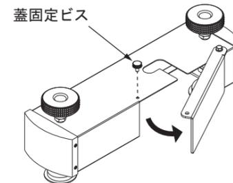
② 蓋を開けたアウトリガーをLEDHUBスタンドの前方キャスターの付け根にスライドするように差し込みます。
