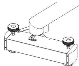
③ アウトリガーを溝に沿って前方へスライドさせます。横方向へ動かないことが確認出来たら①で開けた蓋を閉め、蓋固定ビスで固定します。
