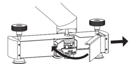
④ 調整用アジャスターを回転させてアウトリガー本体がスタンドの底面に当たるくらいの高さに調整します。
