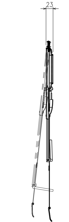
クイックリリーススタンド (TVケーブル着脱時使用)
