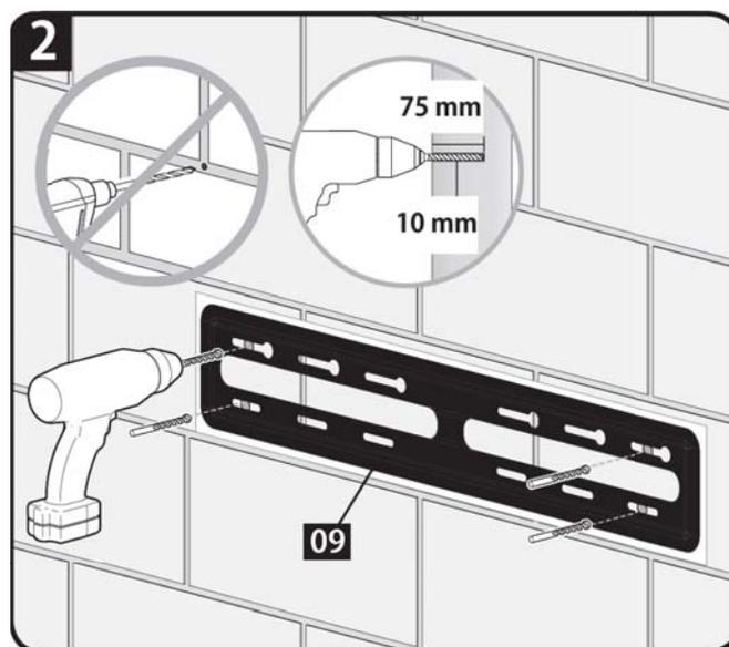
3. 壁掛金具型紙 [09] を取り除いてから、2. で開けた下穴に 4 個のコンクリートアンカー [13] を挿入します。
