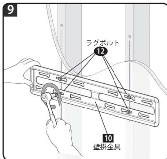
**重要**：最初のラグボルト [12] を締め付ける時、壁掛金具 [10] が所定の位置からずれないようにしっかり支えて下さい。適切に作業しないと、ラグボルト [12] でしっかりと支えることができません。またこのとき、必要以上にラグボルト [12] を締めつけ過ぎないようにご注意ください。
