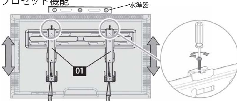
調節ネジを回して水平度の微調整が行えます。
