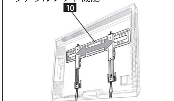
ラテラルシフト - 壁掛金具の装着後も壁側ベース金具の横幅の範囲内で、テレビを壁に取り付けた後でも水平方向に移動させることが出来ます。
