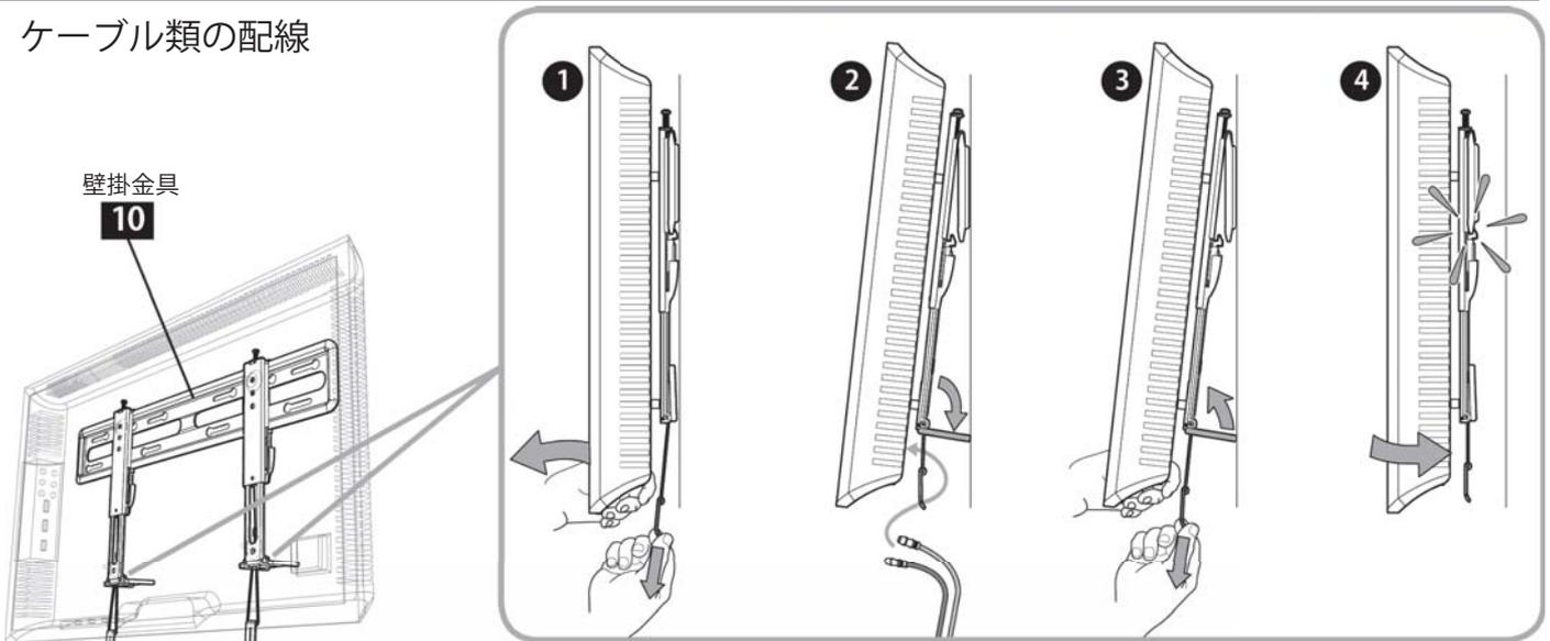
ケーブル類の配線を行うときは、図のようにリリースタブを引いて、TV ブラケットのスタンドを起し、壁側の隙間を作って作業を行ってください。再度、リリースタブを引くことにより、スタンドが収納できます。
