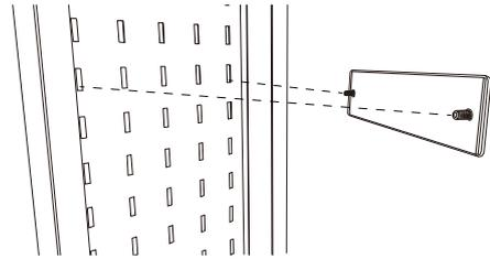
2. スタンド前面から固定プレートのボルト部分にサウンドバー取付金具(本体)の丸穴を通します。
