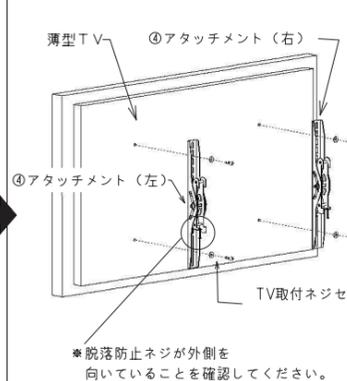
アタッチメント左・右 各1個(左右対称)をTV取付用ネジセットより、TV本体に設けられたネジ寸法に合ったものを選定のうえ、取付けてください。TVの機種によってはTV背面とアタッチメントの間に樹脂スペーサーが必要な場合があります。
