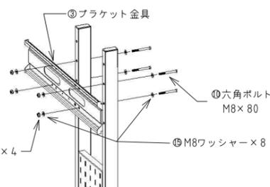
ブラケット金具を支柱フレームに六角穴付きボルトM8×80、M8ナット、M8ワッシャーで好みの高さ(3段階)を選び4ヶ所締め付けます。
