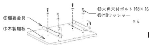
木製棚板に棚板金具(向きに注意)を取付します。棚板裏側に六角穴付ボルト M8×16、M8ワッシャーで左右2カ所ずつ締め付けます。
