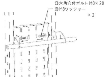
移動用ハンドルを支柱フレーム背面に六角穴付きボルトM8×20、M8ワッシャーで2ヶ所締め付けます。
