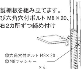
支柱フレームに木製棚板を組み立てます。好みの高さを選び六角穴付ボルト M8×20、M8ワッシャーで左右2カ所ずつ締め付けます。
