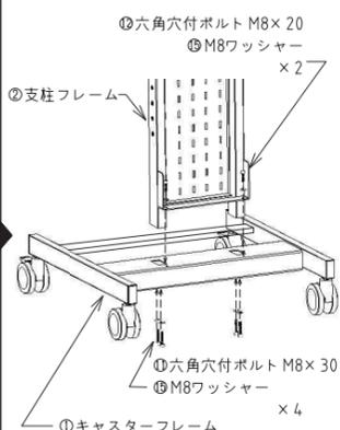
キャスターフレームに支柱フレーム(前後の向きを確認してください。)を差し込み、キャスターフレームの上部を六角穴付きボルトM8×20、M8ワッシャーで2ヶ所、下部を六角穴付きボルトM8×30、M8ワッシャーで4ヶ所六角レンチを用いて締め付けます。
