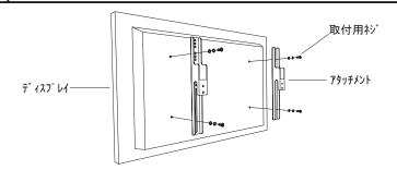
アタッチメント2個(左右共通)をディスプレイ背面に取付ます。 部品箱中のビスパックよりディスプレイ本体に設けられたネジ寸法にあった物を選定の上、取
