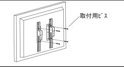
VESAプレート付アタッチメントをディスプレイ背面に取付ま す。取付用ビスは同梱のビスよりディスプレイ本体に設けられた ネジ寸法にあった物を選定の上、取付てください。
