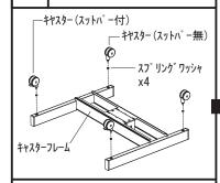
キャスターフレームのナットが見え る部分を上にしてキャスター(ストッ パー付×2(前)・ストッパー無×2(後))、 スプリングワッシャ×4 をスパナを 用いてしっかりと締め付けて下さい。
