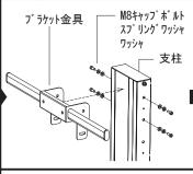
ブラケット金具を支柱にM8キャッ プボルト、スプリングワッシャ、 ワッシャで左右各2ヶ所を締め付け
