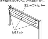
⑥シャフトカバーにある3カ所の引掛け部分がブラケット のボルトに掛かっていることを確認できたら、M6ナットを 締め付けて固定します。
