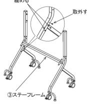
緩めたボルトに③ステーフレームの先端を 引掛けます。
