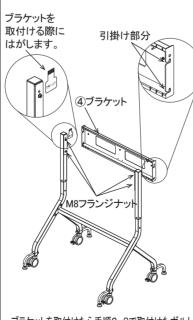
ブラケットを取付けたら手順2、3で取付けたボルト とナットを全て締め付けて固定します。
