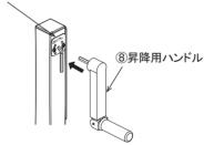
取付けたハンドルを回してスタンドが正常に昇降する か確認してください。操作時は支柱に印字された目盛
