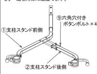
それぞれの支柱スタンドの組立が完了したら 下図のように前後のアウトリガーを内側方向と 外側方向にそれぞれ90°回転させ、アジャスタ -の高さを調整して自立させます。 スタンドの上段にあるボルト部分が向かい合う ように配置します。
