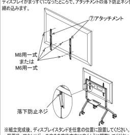
設置後、アウトリガーの向きを前後方向に向くように調整してください。 最後にアジャスター部分にあるナットを上方向に締め込みます。
