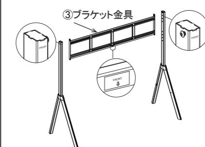
左右の支柱スタンドにブラケット金具上部が掛かっていることが確認出来たらブラケット金具の下部を⑧六角穴付きボタンボルトで固定します。この時、ボタンボルトは締め付けないようにしてください。
