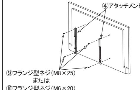
ディスプレイをブラケット金具に引掛けます。左右のアタッチメント上部が確実にかかっていることを確認したらアタッチメント下部がブラケット金具にあたるまでゆっくりと降ろします。ディスプレイがまっすぐにになったところで、アタッチメントの落下防止ネジを締め込みます。
