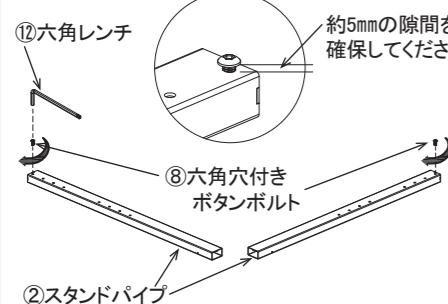
②スタンドパイプと①支柱脚をネジ穴が上に向くように置きます。①支柱脚の先端の突起部分に②スタンドパイプを差し⑧六角穴付きボタンボルトを2本使用して締め付けます。もう一組も同様に組立てます。
