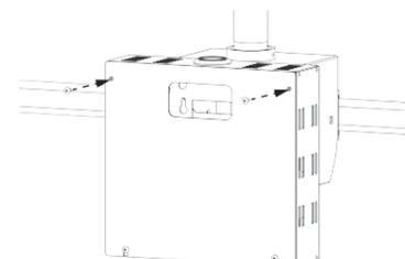
※KDH、KDHV(旧タイプ)の背面カバーに通線用スリットが無いものへ取付ける場合はディスプレイハンガー本体の背面カバーを取外してから背面カバー取付ビスを用いて取付けてください。
