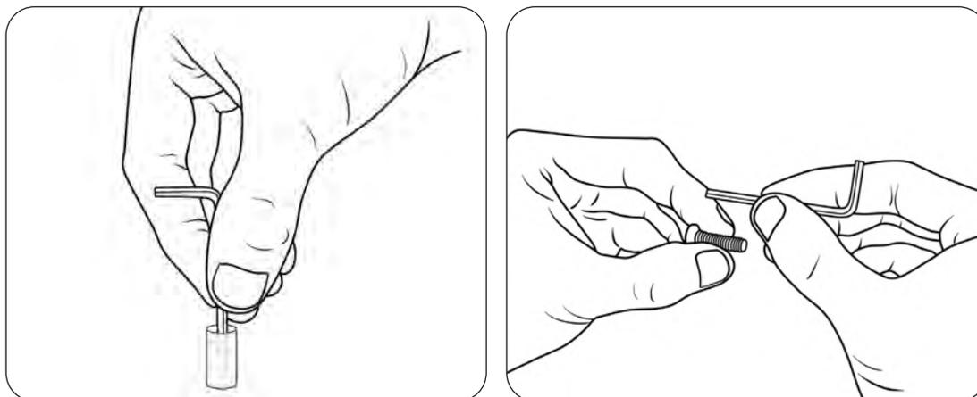
図のように、付属のプラスネジ(G)、またはディスプレイメーカー指定のビスを使用し、ディスプレイ金具(O)をディスプレイに取り付けます。
