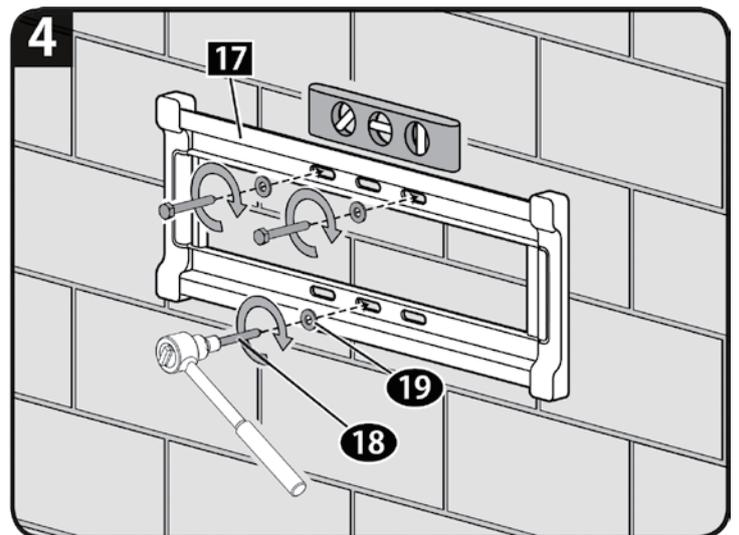
4. 3本のラグボルト [18] とワッシャー [19] を壁掛金具 [17] にしっかりと締めつけて、壁掛金具 [17] を固定します。
