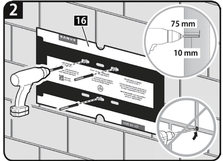
2. 下穴は、10mm径のドリルビットを使って、必ず75mmの深さに穴を3個開けます。
