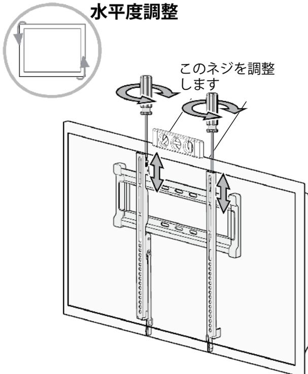
テレビの水平度は、必要に応じて TV ブラケット [01] または [02] の図に示した部分のネジを締め (或いは) 緩めて、調整します。
