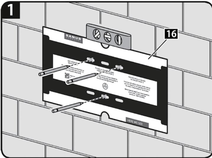
1. 壁面の希望の高さに、壁掛金具型紙[16]を配置します。型紙は水準器で水平を確認してから、穴位置に3箇所のマーキングを付けます。
