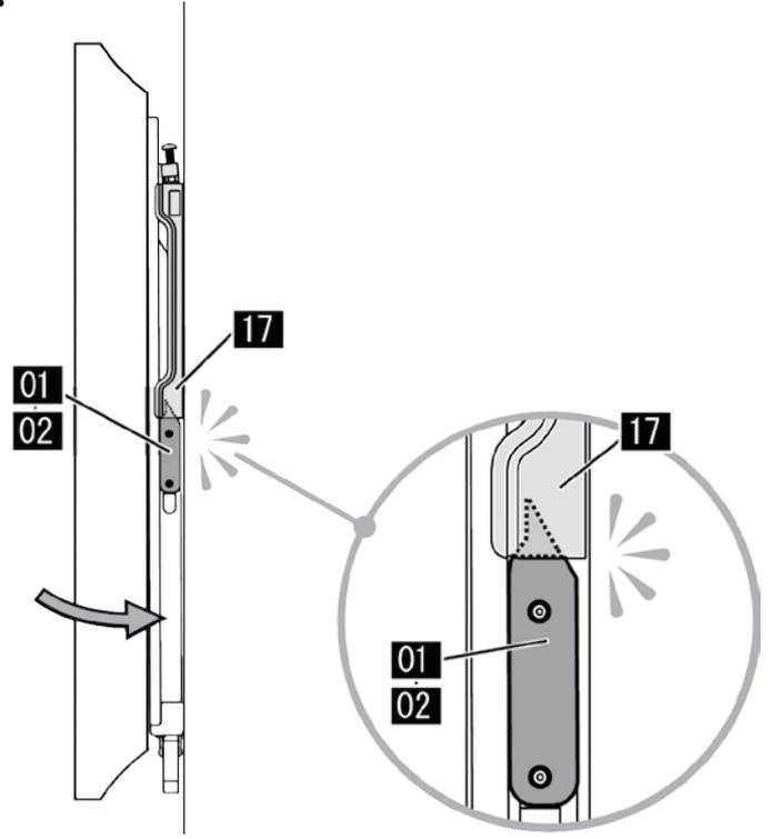
1. STEP 1 でテレビに取付けた TV ブラケット [01] または [02] の上部のスリットを壁掛金具 [17] の上部に引っ掛けて取り付けます。
