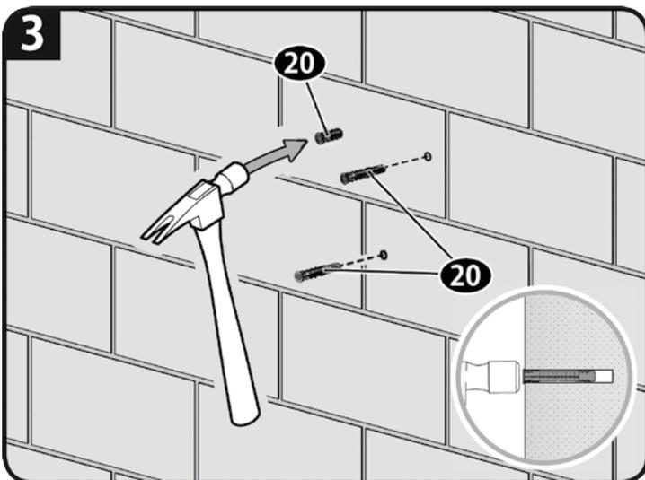
3. 壁掛金具型紙 [16] を取り除いてから、3個のコンクリートアンカー [20] を壁面に打ち込みます。
