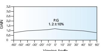
4K の高精細映像に対応したマットスクリーンです。反射光率が高く色鮮やかに映しつつ拡散性にも優れ、広視野角です。超短焦点プロジェクター対応巻上フラットスクリーンにも採用。
