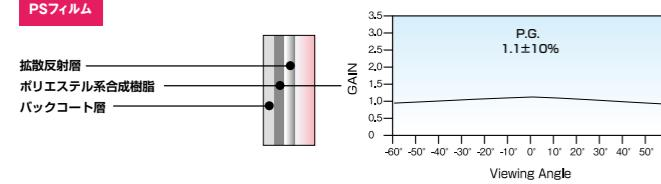
ポリエチル系合成紙をベースに映像用に調合しホワイトインクをプリントした、より環境改善の貢献に特化したフィルムスクリーンです。従来の PW フィルムよりギラつきを軽減し、よりナチュラルな映像を再現します。
