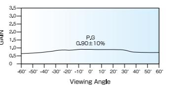
白色塗料をスクリーン面に均一に塗布し、表面にエンボス加工と艶消し処理を施した広いビューアングルを持つベーシックスクリーン。
