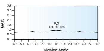
プロジェクターからの入射光を全ての方向へ均等に拡散し、どの角度からも均一の映像を見ることが出来ます。スクリーン表面に特殊柄精細凹凸加工を施すことによりホットスポットを極限まで抑え、プロジェクター光との干渉縞(モアレ)の低減をしています。
