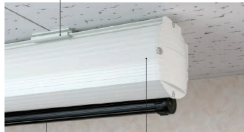
幕面シワの自動調整機能 アルミパイプ内部にテンションスプリングを内蔵。テンションスプリングにより適度なテンションで幕面をフラットに保ちます。 ケース色はホワイトを採用。デザイン性のあるケースで様々な環境に溶け込みます。
