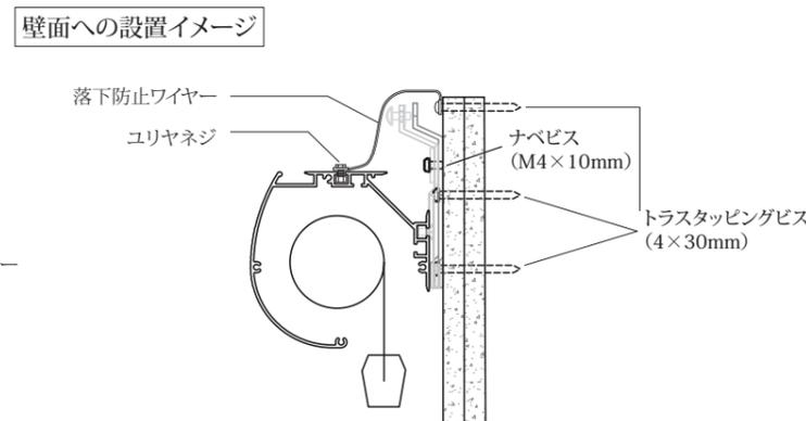
**警告** 取り付ける場所の強度を十分に確認し、しっかりと固定してください。落下の危険があります。
