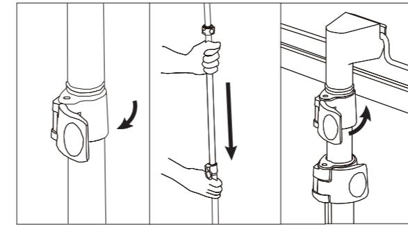
(2) 先端フックに掛かっていた吊りカンワイヤーを外しケースに収納します。
