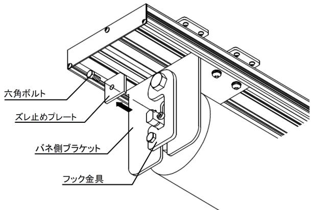
バネ側ブラケットのスレ止めプレートの六角ボルトを緩めて取り、フック金具の六角ボルトを外し、巻取パイプを持ち上げ、フック金具から外しバネ用ブラケットから巻取パイプをスライドさせて外します。
