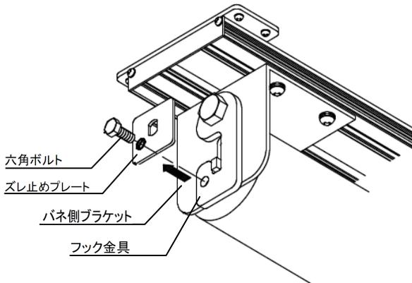
バネ側ブラケットのスレ止めプレートの六角ボルトを緩めて取り、巻取パイプを少し持ち上げ、フック金具から外しバネ側ブラケットから巻取パイプをスライドさせて外します。
