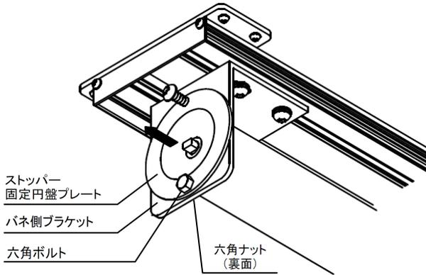
バネ側ブラケットの六角ナット（裏面）と六角ボルトを緩めて取り、ストッパー固定円盤プレートを引っ張りながら、バネ側ブラケットから巻取パイプをスライドさせて外します。
