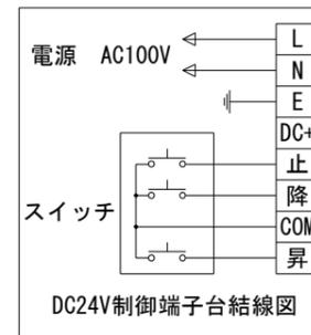
電源線 AC100V/5A φ1.6×20+E (1次側) 別途工事
