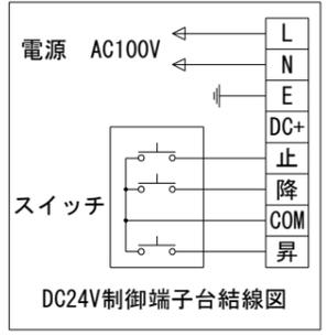
電源線 AC100V/5A φ1.6×20+E (1次側) 別途工事
