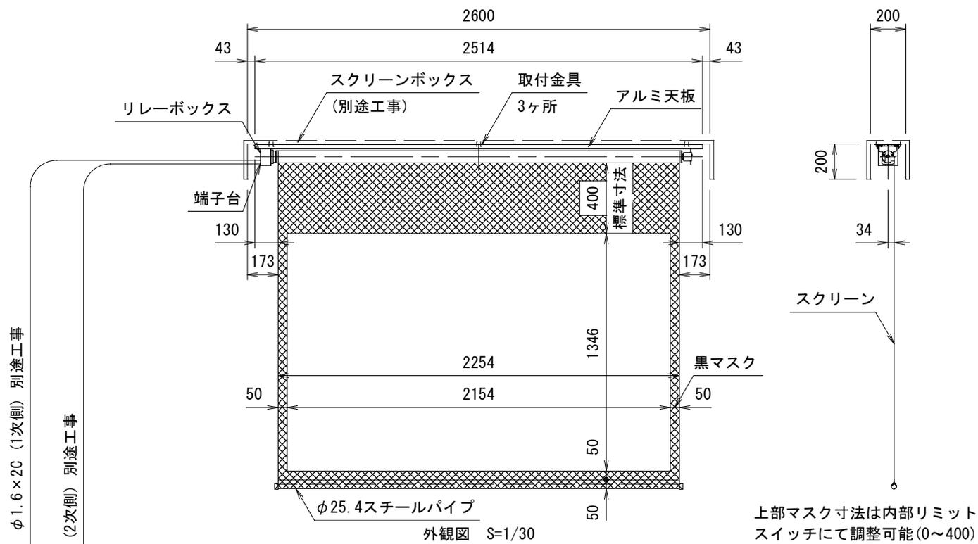
上部マスク寸法は内部リミットスイッチにて調整可能(0~400)
