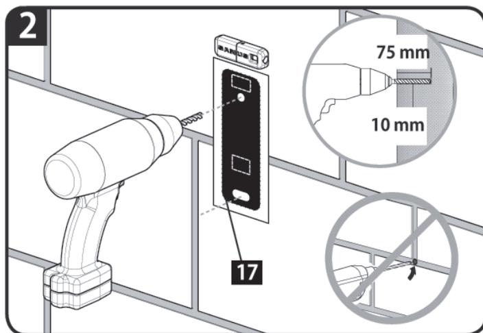
1. 壁面の希望の高さに、壁掛金具型紙[17]を配置します。壁掛金具型紙[17]は水準器[19]で水平を確認してから、穴位置に2箇所のマーキングを付けます。
