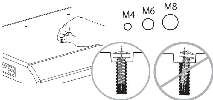
**注意** ご使用のテレビに対して、ネジやスペーサーを組み合わせて、適正なネジ山のかみ合わせを確認して下さい。首下の短いネジは、テレビを十分保持できず、首下の長すぎるネジは、テレビの内部に損傷を与える恐れがあります。
