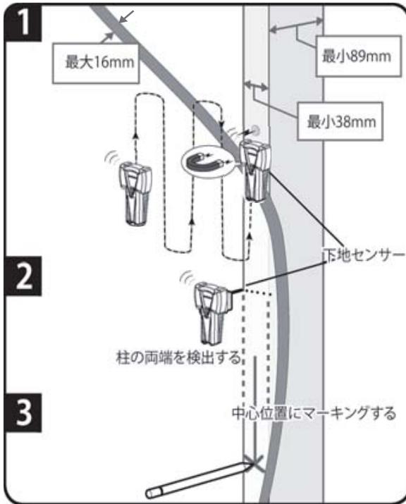
**注記:** 下地センサー(木柱センサー)は壁の中にある下地材をセンサーで感知して知らせるものです。
