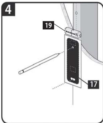
4. 壁掛金具型紙 [17] を使用し、2ヶ所の穴位置に印を付けます。このとき水準器 [19] を使用し床面と水平になるようにしてください。
