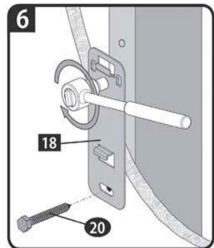
6. 2つのネジ穴にラグボルト [20] を差し込んで、水準器で水平を確認しながら、壁掛金具 [18] にしっかりと引っ張り込まれるまで締めつけて、壁掛金具 [18] を固定します。
