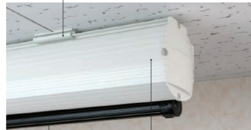
幕面シワの自動調整機能 アルミパイプ内部にテンションスプリングを内蔵。テンションスプリングにより適度なテンションで幕面をフラットに保ちます。 ケース色はホワイトを採用。デザイン性のあるケースで様々な環境に溶け込みます。
