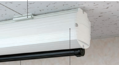
幕面シワの自動調整機能 アルミパイプ内部にテンションスプリングを内蔵。テンションスプリングにより適度なテンションで幕面をフラットに保ちます。 取付金具は前面から目立ちません。 ケース色はホワイトを採用。デザイン性のあるケースで様々な環境に溶け込みます。
